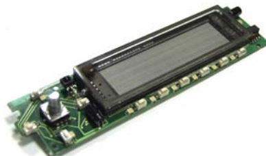
Рис. 3. Печатная плата съемной панели управления
